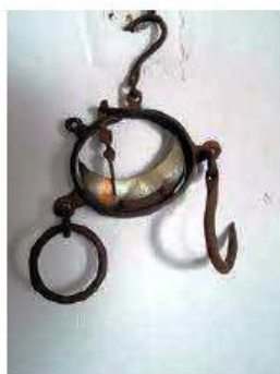
9.- Peso de bolsillo. Muy extendido desde Portugal. Constaba de diferentes argollas para pesar objetos de distinto tamaño.
