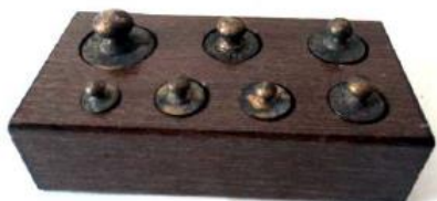
14.- Juego de pesas en metal dorado. Las pesas mayores tenían un pequeño orificio por donde se introducía arena que servía para alcanzar el peso exacto.
