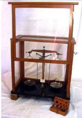
7.- Balanza de precisión. Para pesar artículos de valor.
