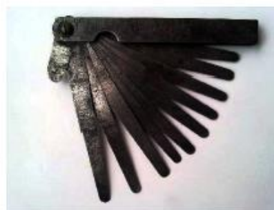
4- Juego de galgas. Para medir el espesor o separación entre dos puntos.
