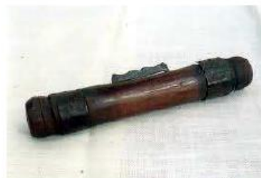
4.- Raseros. Servían para rasar la superficie del recipiente.
