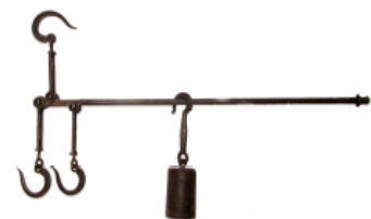
3.- Romana. Consta de dos brazos desiguales que se equilibran mediante contrapesos. Permiten medir distintas unidades: Kilo, arroba.
