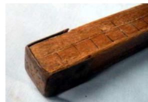
2.- Metro para telas. Hechos con madera de calidad para evitar que se cuartearan con los años. Se remataban en cantoneras de latón en los extremos.
