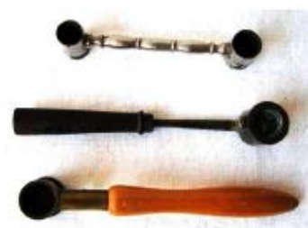
6.- Juego de medidas para pólvora. Permitía medir la cantidad de pólvora con la que se rellenaban los cartuchos de caza. Su fondo iba a rosca, por lo que se podía graduar la cantidad a rellenar.
