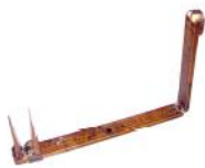
8.- Cartabón o marco de zapatero. Usados para tomar la medida del pie para fabricar el zapato.
