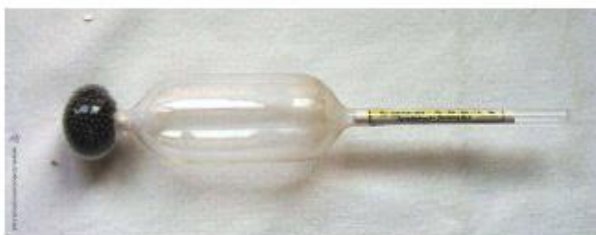
3.- Densímetro. Para comprobar la calidad de la leche, vino, aguardiente o vinagre. Se introducían en el líquido a analizar y se veía hasta que punto se hundían.
